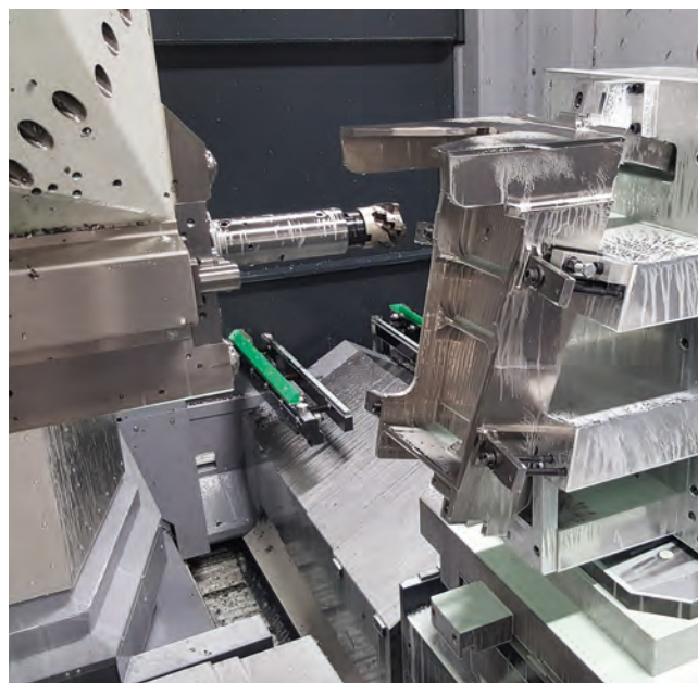
Struktur-Flügelteil für einen Business Jet aus einem Titanschmiedeteil der Firma voestalpine BÖHLER Aerospace GmbH & Co KG.
